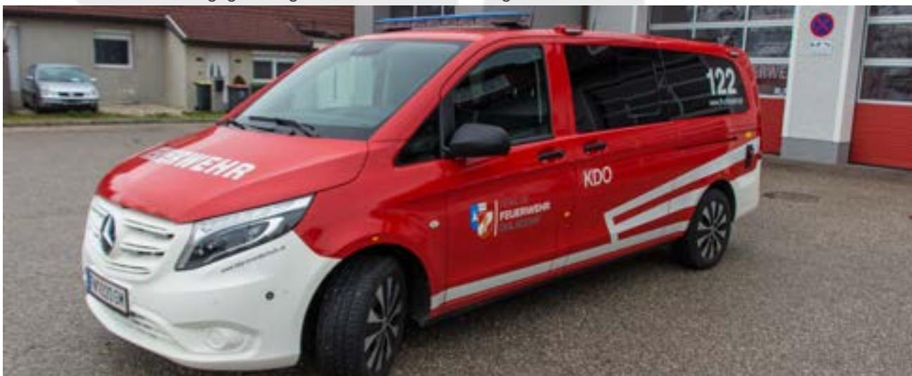
**Technische Daten: Mercedes-Benz, Vito Tourer (langer Radstand), Allrad, 190 PS, elektrische Fensterheber, Klimaanlage etc., Baujahr 2021, Besatzung 1:3**
