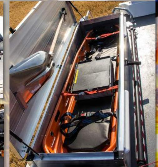
untergebracht. All diese Einsatzgeräte wurden in den ersten Wochen bereits bei Einsätzen benötigt. Um jeden Zentimeter Platz zu nutzen wurde innen am Deckel der Schleifkorbtrage eine Fassschaufel montiert. Zur Sicherheit auf der Straße wurde hinten am Dach ein Verkehrsleitsystem aufgebaut mit fixen Infomeldungen für nachkommende Verkehrsteilnehmer.
