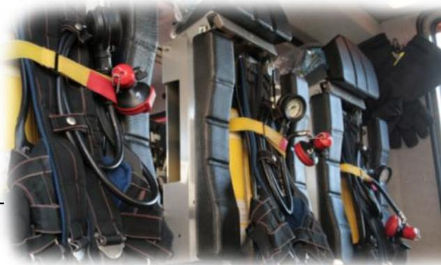
Jährliche Überprüfungen der Masken, der Flaschen und der Tragegestelle stehen natürlich auch auf dem Programm. Gefüllt werden die leeren Flaschen bei der Betriebsfeuerwehr Steyermühl, welche einen Füllkompressor und das Atemschutzfahrzeug des Bezirkes stationiert hat.
